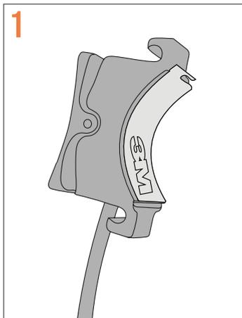
1 Remova a proteção da fita 3M
